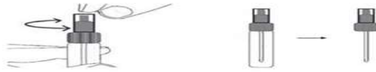
نحوه باز کردن لوله جمع آوری نمونه
